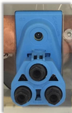
Bornes à perforation d'isolant pour câble cuivre rigide de 10 à 25mm 2 et Alu rigide de 16 à 35mm 2 , Couple de serrage de 9Nm
